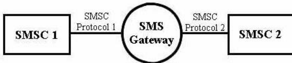
Hình 1.2: SMS Gateway với chức năng chuyển tiếp
